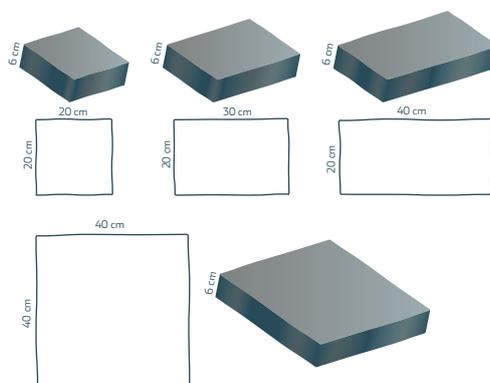
\* Dimensions en cm mentionnées à titre indicatif pouvant être soumises à variation suivant les tolérances dimensionnelles spécifiées dans la norme "produit" pavés de voirie NF EN 1338. Masse au m<sup>2</sup> en épaisseur 6 cm de l'ordre de 140 Kg.
