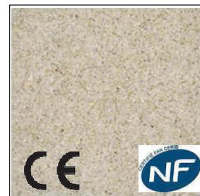
La couche supérieure décorative de la dalle gravillonnée MONTAIGNE est composée d'un mélange de ciment blanc et d'additifs à base de granulats décoratifs de qualité supérieure. La sous-couche est un mélange de ciment et d'additifs à base de granulats sélectionnés pour leurs performances et leur apparence.
