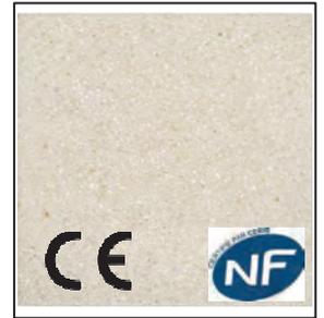
La couche supérieure décorative de la dalle gravillonnée GRANULINE est composée d'un mélange de ciment blanc et d'additifs à base de granulats décoratifs de qualité supérieure. La sous-couche est un mélange de ciment et d'additifs à base de granulats sélectionnés pour leurs performances et leur apparence.
