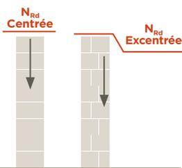
Exemples de valeurs de calcul selon l'Eurocode 6 de la résistance aux charges verticales d'un mur de maçonnerie composé de blocs KOSMO CITY.
