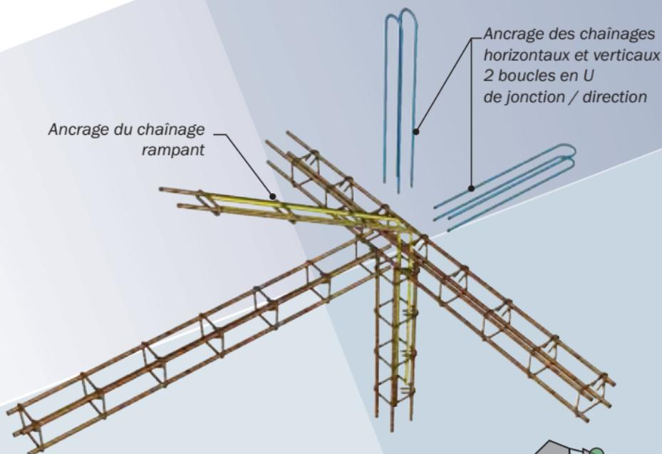
*Détail d'une jonction d'angle en T avec le chaînage du rampant*
