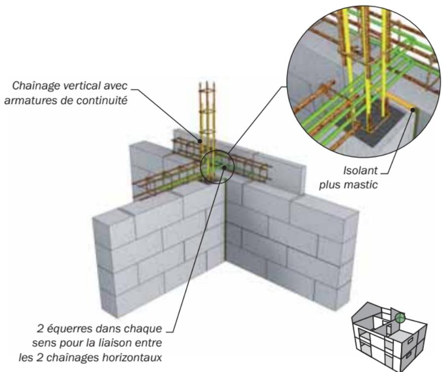
**Jonction par juxtaposition avec un isolant intercalé (pour améliorer les performances thermiques, recommandée pour les locaux chauffés)**
