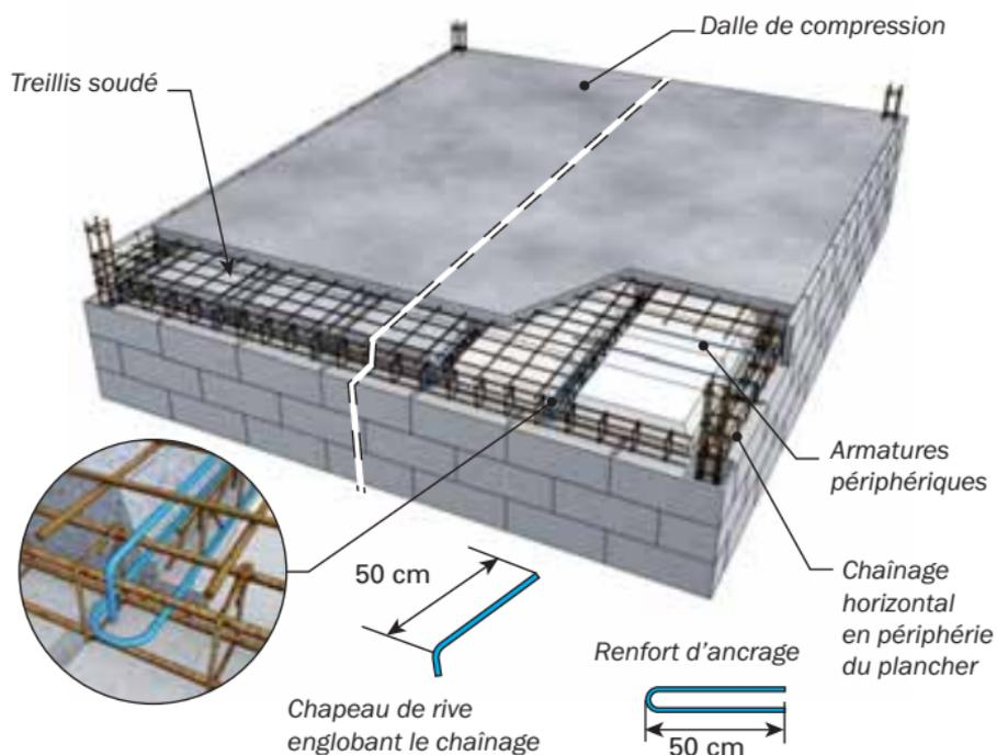
**Détails des chaînages aux jonctions entre murs et planchers**
