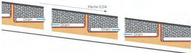
Exemple de stockage sous chaussée et trottoirs à forte pente
