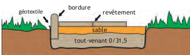
Si le sol est imperméable, un drainage du lit de pose doit être réalisé. Pour cela, une couche de sable grossier sera déposée en périphérie, complété éventuellement par une évacuation en fonction de la configuration de l'ouvrage.
