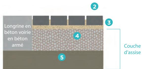
**Exemple de blocage des rives au moyen d'une longrine en béton**
