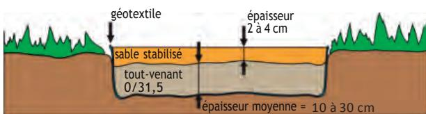
Le fond de forme doit être compacté à l'aide d'une plaque vibrante, et respecter les pentes de l'ouvrage qui seront assurées pour chaque couche d'assise, de pose, et de revêtement.
