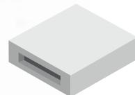
Détrompeur à placer toujours dans le même sens pour des joints alignés
