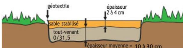
Le fond de forme doit être compacté à l'aide d'une plaque vibrante, et respecter les pentes de l'ouvrage qui seront assurées pour chaque couche d'assise, de pose, et de revêtement.
