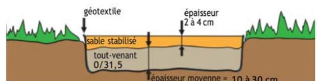
Le fond de forme doit être compacté à l'aide d'une plaque vibrante, et respecter les pentes de l'ouvrage
