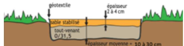
Le fond de forme doit être compacté à l'aide d'une plaque vibrante, et respecter les pentes de l'ouvrage qui seront assurées pour chaque couche d'assise, de pose, et de revêtement.
