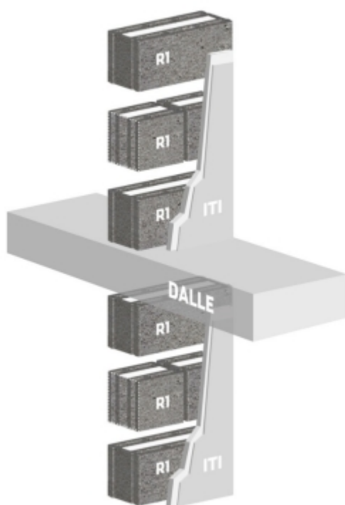
Exemple de traitement du pont thermique d'un plancher intermédiaire, au niveau d'un balcon
