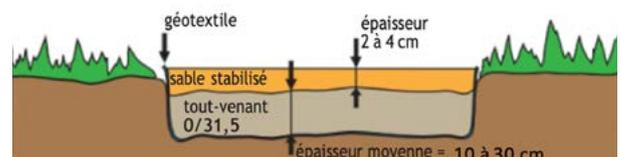
Le fond de forme doit être compacté à l'aide d'une plaque vibrante, et respecter les pentes de l'ouvrage
