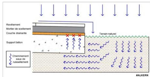
Un drainage périphérique de l'ouvrage est notamment indispensable lorsque le niveau du terrain naturel est plus élevé que le niveau de la couche drainante afin que les eaux de ruissellement ne soient pas renvoyées vers le revêtement (cf. schémas ci-contre).
