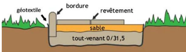
Si le sol est imperméable, un drainage du lit de pose doit être réalisé. Pour cela, une couche de sable grossier sera déposée en périphérie, complétée éventuellement par une évacuation en fonction de la configuration de l'ouvrage.
