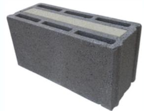
Pose au mortier - colle à joints minces (joints horizontaux durcis d'épaisseur 1 à 3 mm), joints verticaux en zone sismique, encollage des coupes conformément au guide de mise en œuvre ALKERN.
