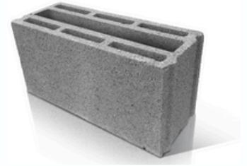
Pose au mortier - colle à joints minces (joints horizontaux durcis d'épaisseur 1 à 3 mm), joints verticaux en zone sismique, encollage des coupes conformément au guide de mise en œuvre ALKERN.
