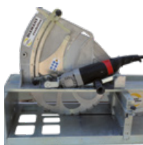
Scie sur table Alkern (220 V, nécessite un groupe électrogène de 3 KW mini)
