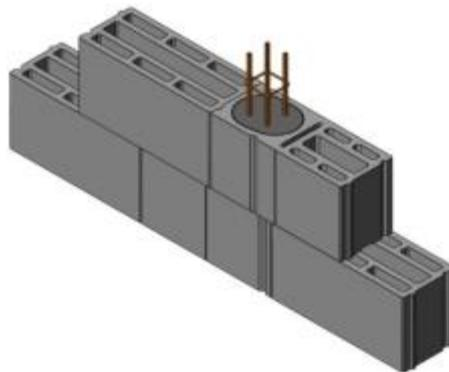
**Figure 9 : Chaînage en partie courante**
