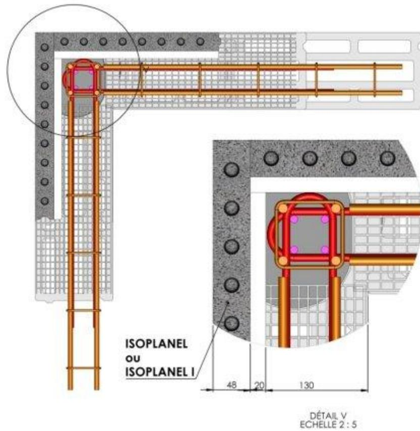
**Figure 15 : Chaînage horizontal (détail ISOPLANEL ou ISOPLANEL I – zone non sismique)**
