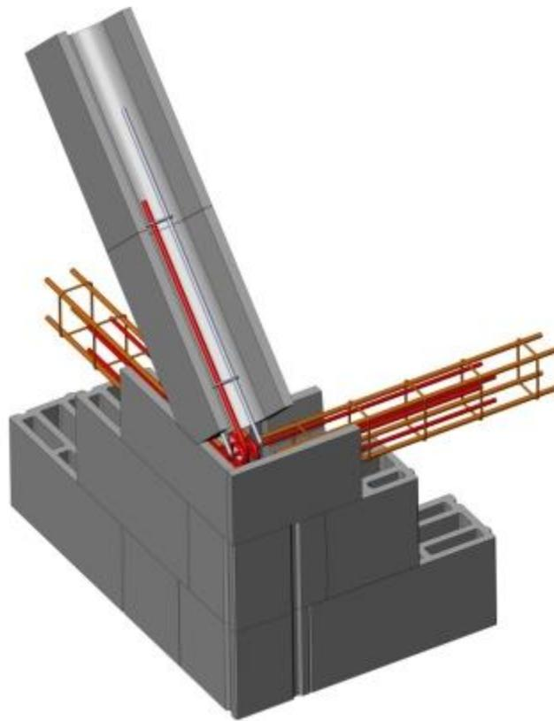
**Figure 21 : Détail des pignons/chaînage des rampants**
