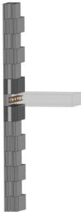
**Figure 18 : Chaînage horizontal (appui de plancher) – Mur « R+Mur »**
