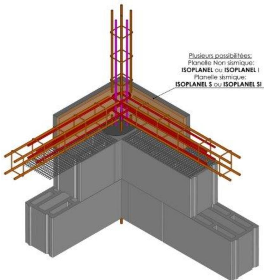
**Figure 14 : Chaînage horizontal (détail des armatures)**
