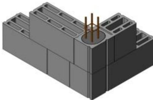
**Figure 8 : Chaînage vertical (angle à 90°)**
