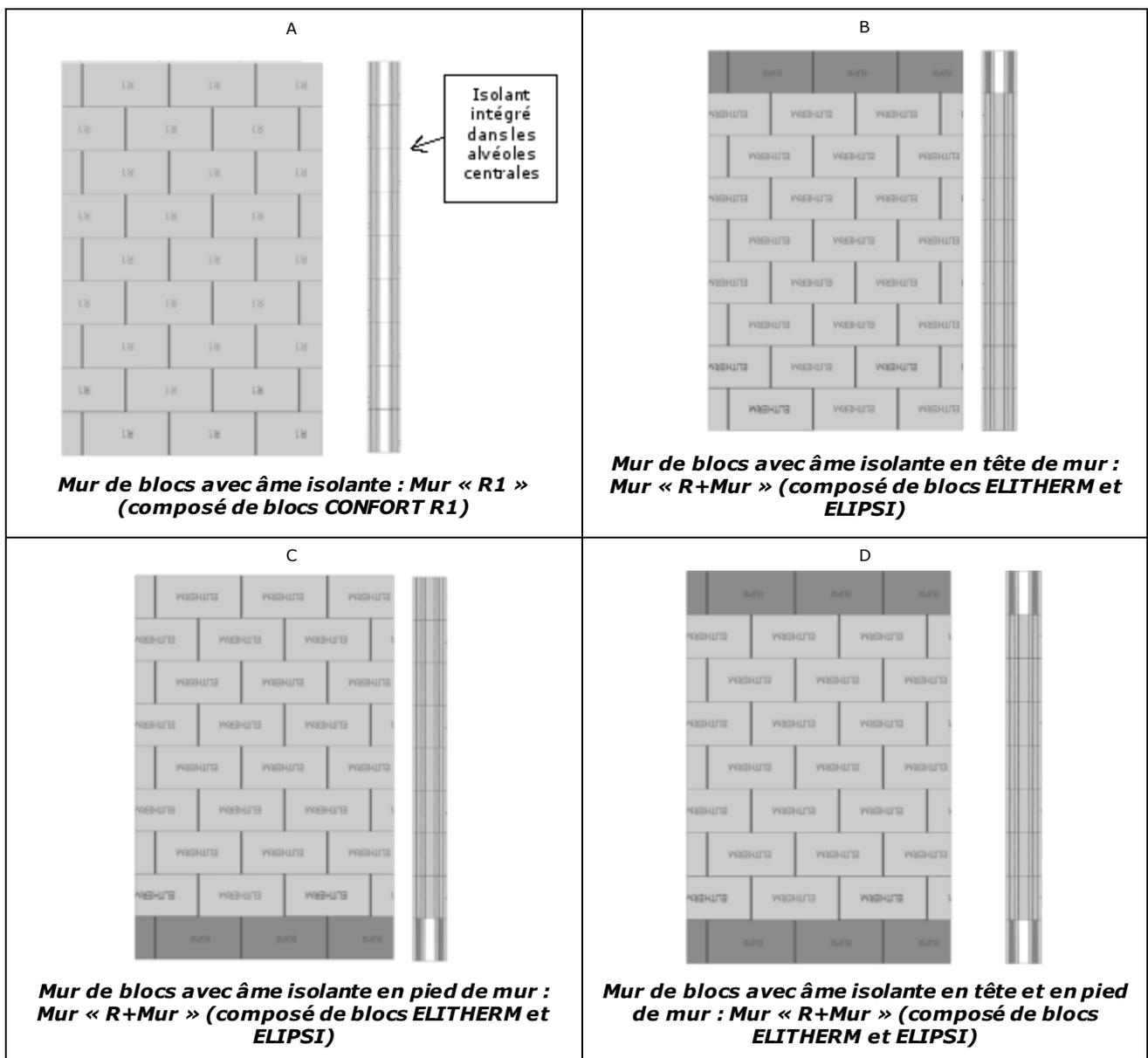
Figure 1 : Schémas de principes des différentes configurations envisageables
