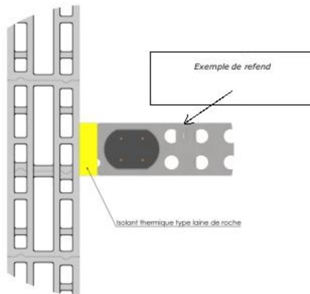
**Figure 11 : Jonction par juxtaposition d'un mur de refend/mur de façade en zones non sismiques**
