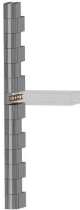
**Figure 17 : Chaînage horizontal (appui de plancher) – Mur « R1 »**
