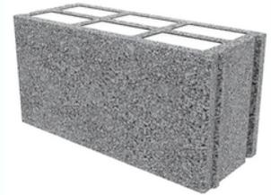
Pose au mortier - colle à joints minces (joints horizontaux durcis d'épaisseur 1 à 3 mm), joints verticaux encollés en zone sismique. Encollage des coupes conformément au guide de mise en œuvre ALKERN.
