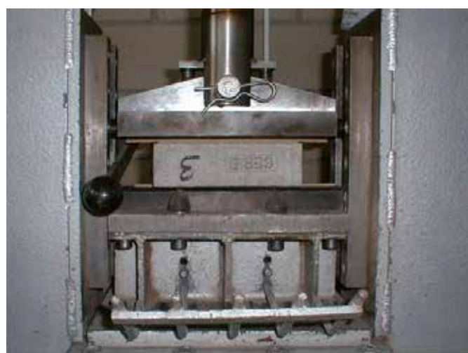
Essai de fendage sur un pavé
