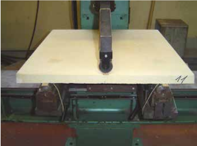
Essai de flexion sur une dalle
