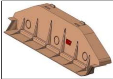
Figure 16 : Entrevous plastique Plastivoute 16 (longueur 766 mm) hauteur coffrante 160 mm Coupe longitudinale
